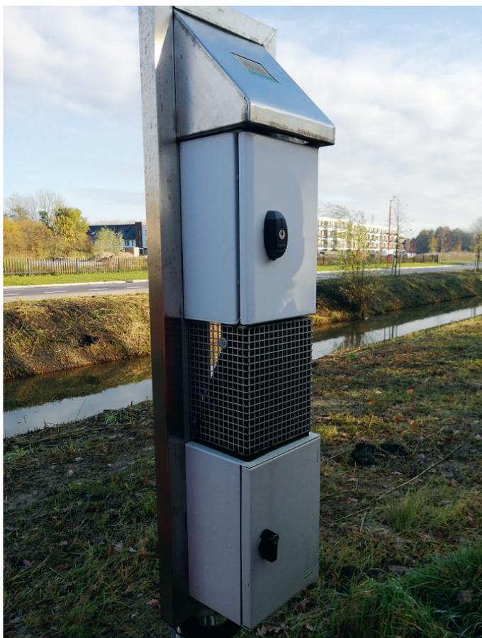
Abb. 1: Wegseitiges System zur Überwachung der Fahrzeuge.
